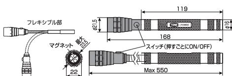
先端にマグネットとLEDを装着し、暗くて狭い場所に落ちたボルト・ナット、工具等を拾うのに便利。
