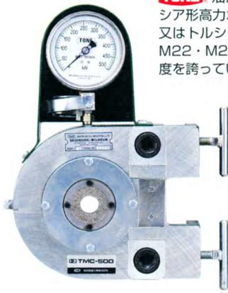
**TONE** 油圧式軸力計 TMC500AT はトルシア形高力ボルトの太径サイズ M27・M30 又はトルシア形超高力ボルト M16・M20・M22・M24 に最適な軸力計で± 3%の高精度を誇っています。
