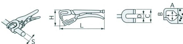
ジョーは2本の管又はアングル断面を端から端まで整列しながら保持する一方で溶接トーチを差し入れるスペースがあります。ジョーは鋳物でボディはプレス抜き。
