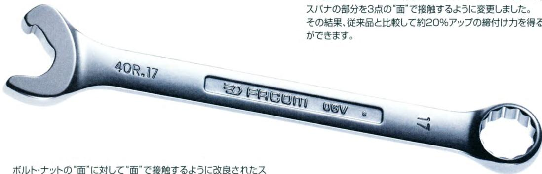
ファコムのファーストアクションコンビネーションレンチは、パワーの伝達をよりスムーズに行うために、ボルト・ナットの“面”に対してスパナの部分を3点の“面”で接触するように変更しました。その結果、従来品と比較して約20%アップの締付け力を得ることができます。
