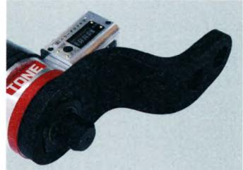
反力受はストレート形とL形の2種類を用意(写真はL形)。また作業環境に合わせて特殊形状の反力受も製作可能(有償)。
