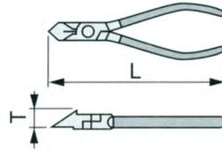
弱電関係の細線や銅線を切る工具です。(鉄線は切れません) 斜ニッパは強力ニッパに比べ切断面が平らになります。
