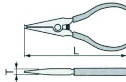
スナップリング軸用・穴用の着脱に使用します。軸位置を変えることにより、軸用・穴用の両方使えます。(SPSH-200)
