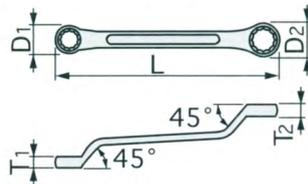
柄部の曲がり角度が45°になっていますので、周辺の障害物を避けて作業ができます。めがね部がリング状になっていますので、ボルト・ナットから外れにくく周囲均等に荷重を受けるため、強力に確実に締付けることができます。めがね部は12角のためボルト・ナットにはめ合わせやすく、比較的狭い場所でも作業が容易です。
