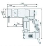
※ M24 用レバーソケット (HRU41T) を 装着した寸法図です。
