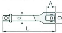
深くて狭い箇所の作業など、ハンドルが操作しにくい時、ソケットを延長させるために使用します。
